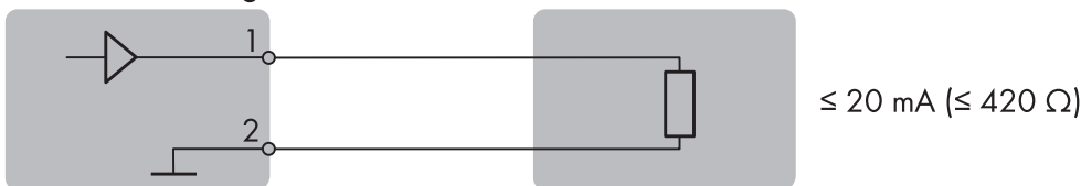
Figure 10 : Raccordement d'un appareil correspondant analogique
